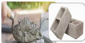
e) Hỗn hợp xi măng, cát và nước đang đông cứng sau khi trộn
