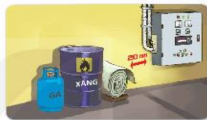
b) Chứa dầu gần tủ điện
