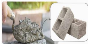
e) Hỗn hợp xi măng, cát và nước đang cứng sau khi trộn
