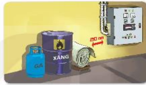
b) Chất đốt để gần tủ điện
