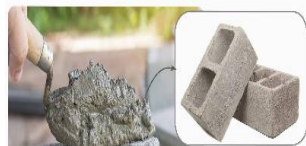
e) Hỗn hợp xi măng, cát và nước đang trộn sau khi trộn
